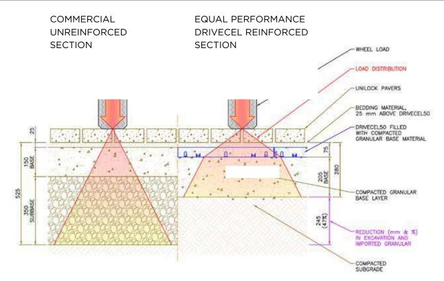
**DRIVECEL GF50 HEAVY DUTY - LOAD DISTRIBUTION**
